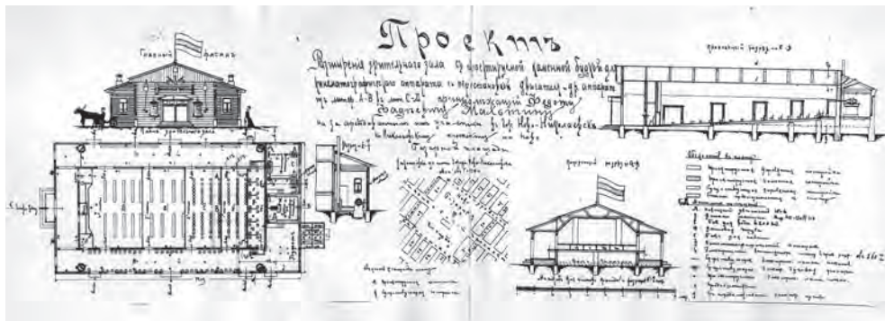
Рис. 1.1.6. «Проект расширения зрительного зала с каменной будкой для кинематографического аппарата» в Новониколаевске (ныне Новосибирске). Ввиду небольшого объема работы вся информация о будущей пристройке к зданию собрана на одном листе. Первые годы XX века. Из коллекции И. Поповского
